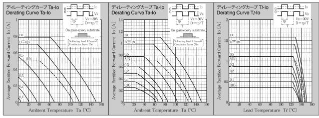
\*1インチプリント基板 (パターン32.6mm²) Measured on 1 x 1 inch substrate (pattern area 32.6mm²)
