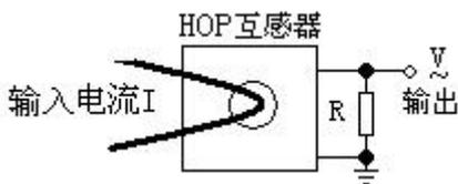
输出并联小于 120 欧电阻, 输入 20A 时输出对应 1.2V 不饱和。输出电压=输出 I\*R。
