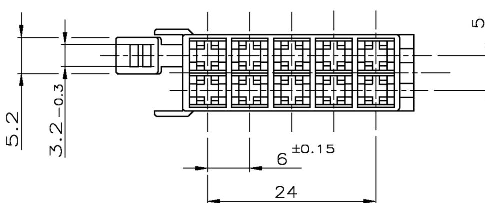
1 Gehäuse mit Verriegelungsleiste
