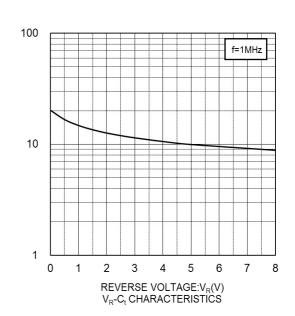
CAPACITANCE BETWEEN TERMINALS:C<sub>t</sub>(pF)
