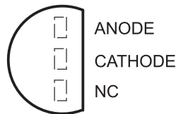
LM285-1.2, LM385-1.2, LM385B-1.2 . . . LP PACKAGE (TOP VIEW)
