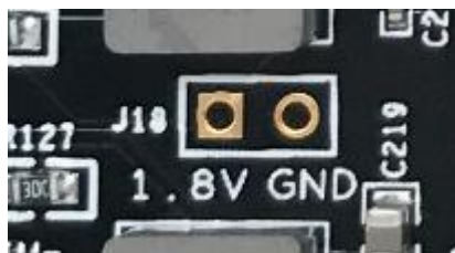
图 3-3 实物图中的电源测试点
