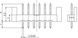
Note : Board Through-hole Diameter :  $\phi$  1.1  $^{+0.1}_{0}$
