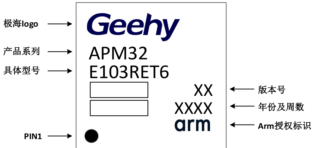
图 26 LQFP64 - 64 引脚，10 x 10mm 封装标识
