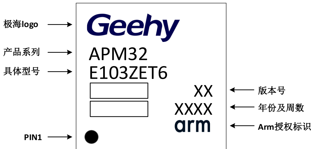
图 20 LQFP144 -144 引脚，20 x20 mm 标识图
