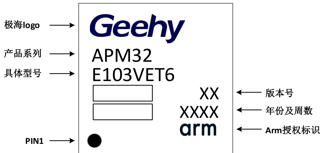
图 23 LQFP100 - 100 引脚，14 x 14mm 封装标识
