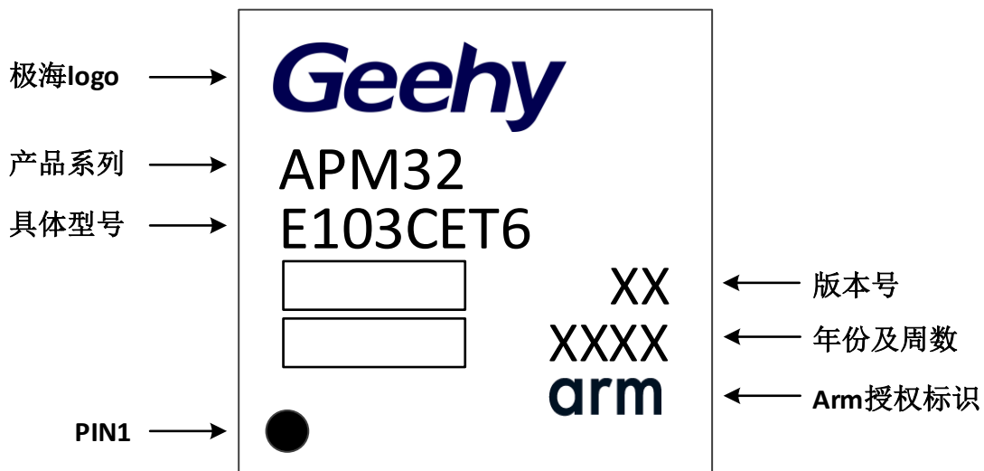
图 29 LQFP48-48 引脚, 7×7mm 标识图
