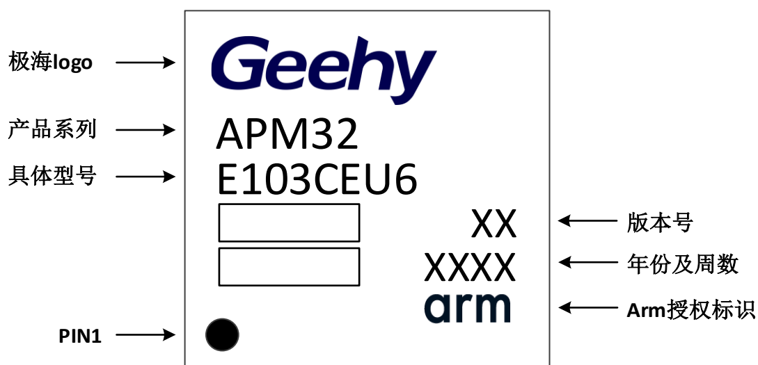
图 32 QFN48-48 引脚 7×7mm 标识图
