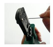
Insert the cable until insulation Stop blade. Leiter bis Iso-Stop Blech einschieben.
