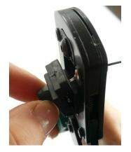
Loosen the Flap locator. Schwenkanschlag lösen.
