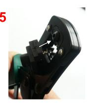
Close the Flap locator. Schwenkanschlag bis Anschlag einschwenken!
