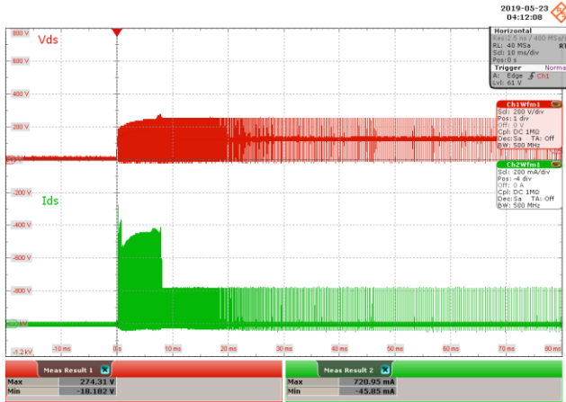
Figure 51 – 85 VAC 60 Hz. CH1: V_{DS} , 200 V / div., 10 ms / div. CH2: I_{DS} , 200 mA / div., 10 ms / div. V_{DS(MAX)} = 274.31 V, I_{DS(MAX)} = 720.95 mA.
