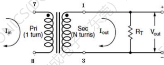
$$B_{\max} = \frac{V_{\text{sense, max}} \cdot \delta_{\max}}{n_s \cdot A_e \cdot f_{\text{osc}}}$$
