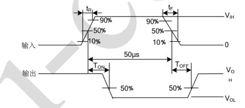
注释 1: 脉冲宽度为 50us, 占空比 10%, 输出阻抗 50Ω,  $t_R$ <=5ns,  $t_F$ <=10ns 输入电压 3V,
