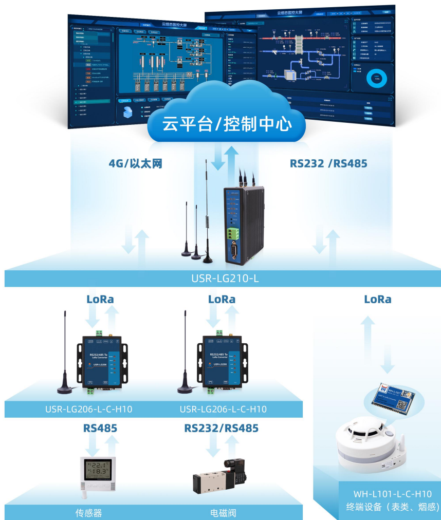
图 1.1 USR-LG210-L 应用框图
