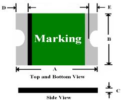
Α В С D Е Part Min Max Min Max Max Min Min Max Min Max Number SMD2920P100TF/60 6.73 7.98 4.80 5.44 0.40 1.70 0.50 1.20 0.50 0.90
