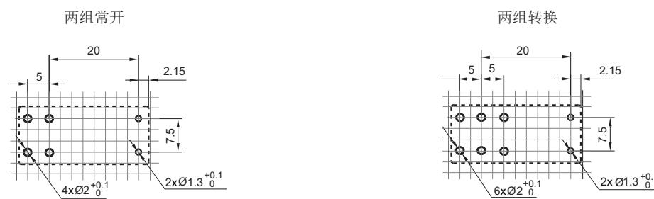
备注: (1) 产品外形图的引脚标注尺寸为沾锡前尺寸(沾锡后会变大), 安装孔尺寸为推荐的PCB板孔的设计尺寸, 具体PCB板孔设计尺寸可根据产品实物进行测绘、调整;
