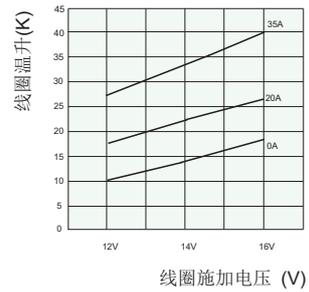
备注: 线圈温升测试时, 继电器安装在PCB板上, PCB板为双层板, 铜箔厚度4oz(140 $\mu$ m), NO和Com端铜箔宽度13.15 $\times$ ( $\pm$ 5%)mm, 铜箔长度50mm $\pm$ 1mm, PCB板Tg值为150°C, 样品安装间距为100mm。
