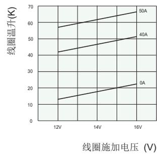
备注: 线圈温升测试时, 继电器安装在PCB板上, PCB板为双层板, 铜箔厚度4oz(140μm), NO和Com端铜箔宽度13.15×(1±5%)mm, 铜箔长度50mm±1mm, PCB板Tg值为150°C, 样品安装间距为100mm.
