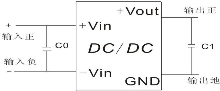
**2、输入反射纹波电流测试电路:**
