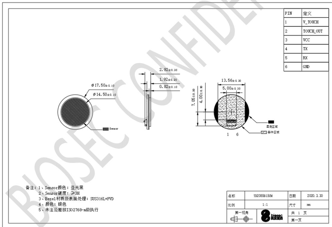
备注: 请务必按图示规定固定区域安装我司模组, 我司将来升级变更产品将保持此安装区域不变; 若超出此区域, 则后续产品不保证结构尺寸能向前兼容!
