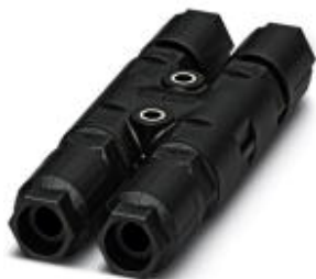
H型分配器，QUICKON速连，位数: 2+PE，0.5 mm 2 ... 1.5 mm 2 ，690 V，17.5 A，黑色，带QUICKON螺母，电缆直径范围: 5 mm ... 9.5 mm，带密封螺栓
