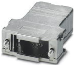
D-SUB插头外壳，保护等级: IP20，标识材料: ABS，金属镀层，电缆出口: 弯头，外壳尺寸: 2，颜色: 裸金属
