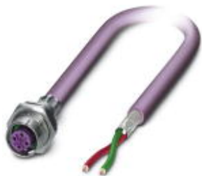
总线系统孔式插座，PROFIBUS，2芯，M12，屏蔽，B编码，SPEEDCON，板后/Pg9螺纹安装，带2.0m总线电缆，2x0.25mm 2
