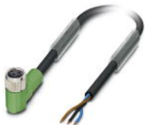
传感器/执行器电缆，3-芯，PVC，黑色 RAL 9005，端自由出线，与孔式弯头 M8，电缆长度: 3 m
