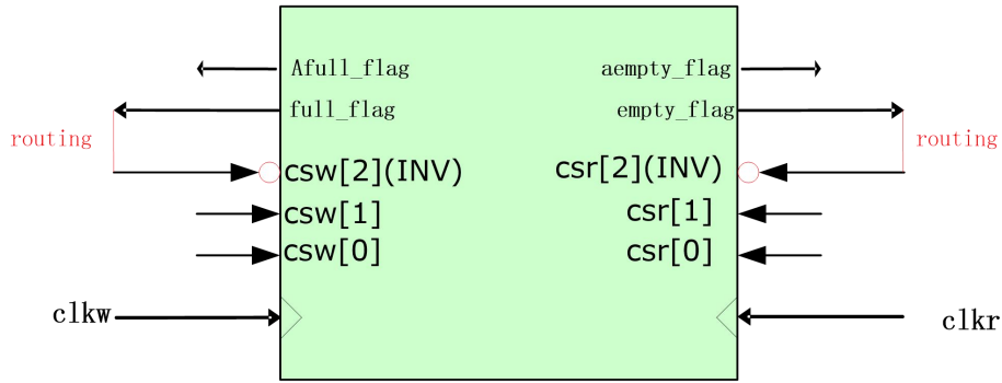
图 2-2- 11 单个 ERAM9K FIFO 模式连接
