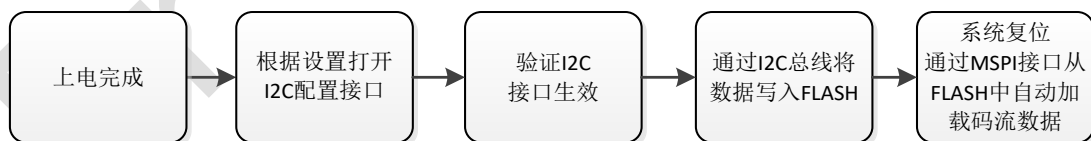
图 2-9-12 cfg 阶段启动 I2C 的流程
