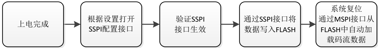
图 2-9-9 配置模式阶段启动 SSPI 的流程
